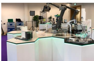
iHex实验室系统的蜂窝模块设置灵活，可通过即插即用形成一个完整的系统
